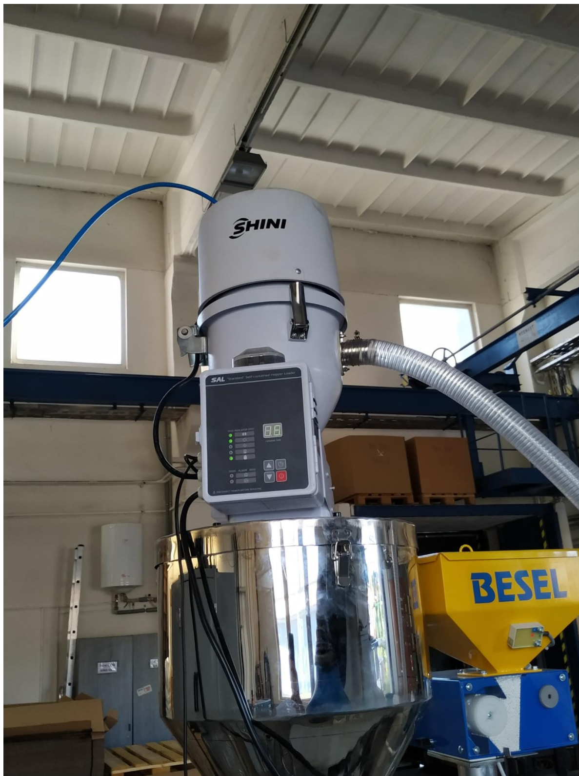
Nasávací zařízení SHINI SAL 330 a volumetrické barvící zařízení BESEL
